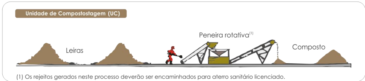
Figura 84 - Ilustração esquemática destacando as “peneiras rotativas” de uma Unidade de Compostagem.
