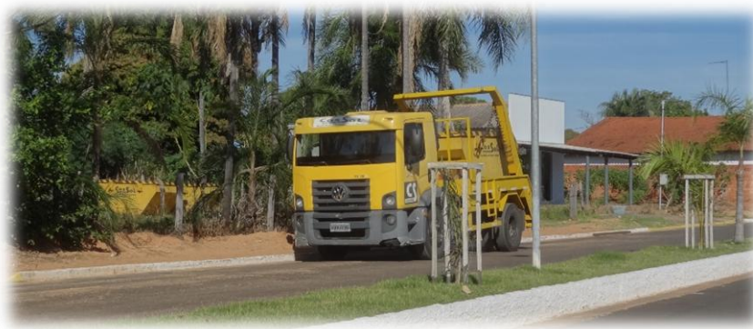
Figura 77 – Caminhão poliguindaste e caçamba para o acondicionamento de resíduos de construção civil, demolição e volumosos no município de Alcinópolis/MS.
